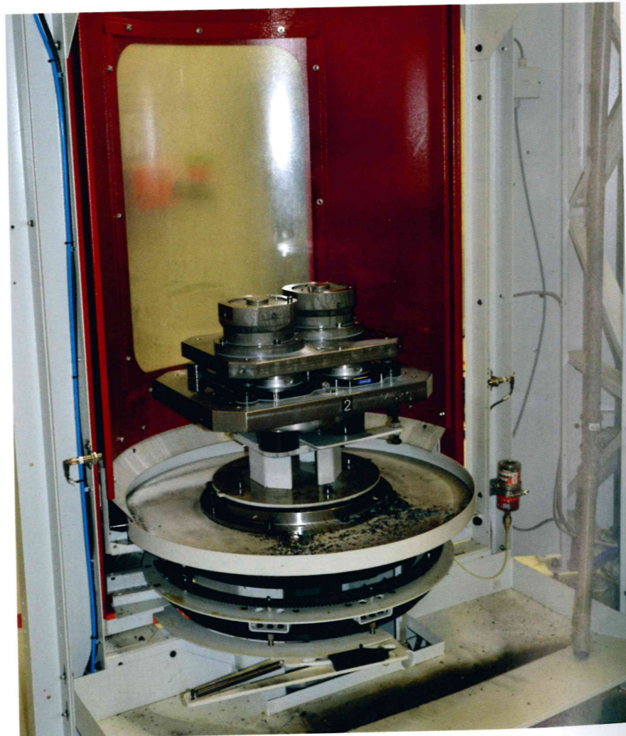
Der integrierte Rüstplatz gleich neben der Bedienerseite der Maschine
