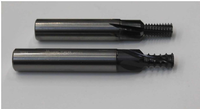
Bild 4: Vergleich Walter TC620 Supreme vs. klassischer Gewindefräser
