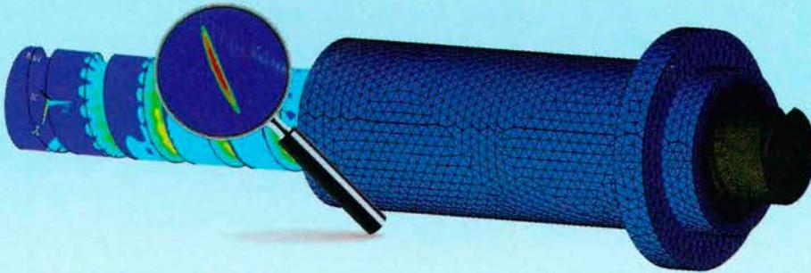
*Die optimale Auslegung dynamisch hochbelasteter Kugelgewindetriebe ist für Maschinenbauer eine Herausforderung, die im allgemeinen relativ viel Zeit und ein gewisses Spezialwissen erfordert. Eine Finite-Elemente-Software mit hinterlegten Modellen soll die Sache leichter machen.*
